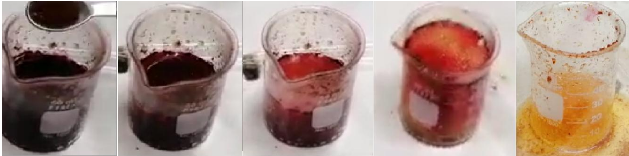
Figura 2. Fotografías en secuencia de la mineralización de ácido carmínico por la reacción de Fenton.
